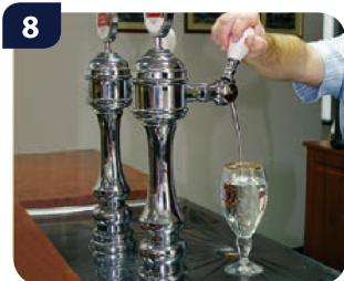
Откройте кран на пивной башне и интенсивно промойте водой пивную линию.
