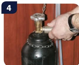
Отсоедините шланг высокого давления от баллона СО<sub>2</sub>. Замените пустой баллон СО<sub>2</sub> на полный.
