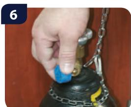
Снимите предохранительную заглушку с нового баллона.
