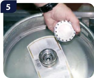
Снимите контрольную пломбу. Контрольную пломбу нового кега необходимо сохранить до полной реализации пива в кеге.
