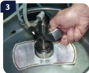
Поднимите ручку заборной головки вверх до упора.
