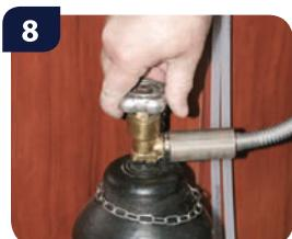
Откройте вентиль на баллоне СО<sub>2</sub> против часовой стрелки.
