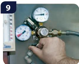
Откройте подачу газа на редукторе и отрегулируйте давление.
