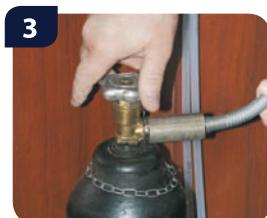
Закройте вентиль на баллоне СО<sub>2</sub> по часовой стрелке.
