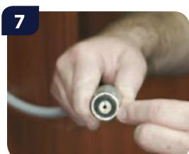
Проверьте наличие и целостность уплотнительной шайбы и зафиксируйте шланг на баллоне.
