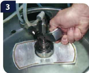
Поднимите ручку заборной головки вверх до упора.
